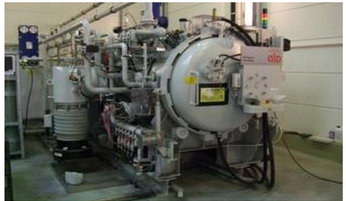
Bild 8: Vakuum-Wärmebehandlungsanlage
