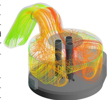
Bild 2: Temperaturströmung, die durch den Spalt zwischen Deckel und Ofengefäß verursacht wird
