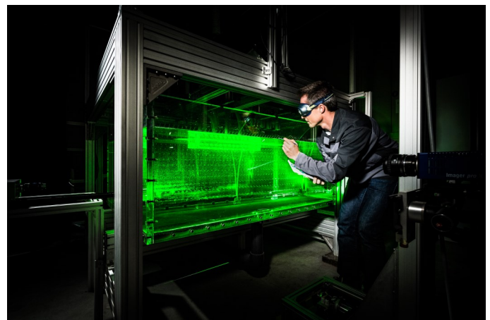
Bild 1: Wassermodell einer Bandgießanlage
