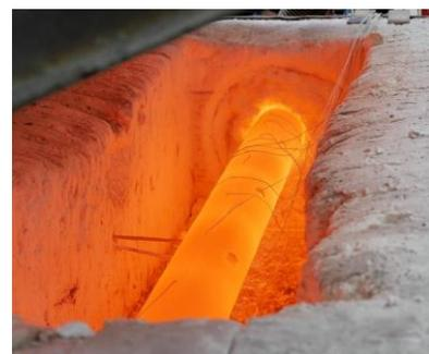
Strahlheizrohr im Versuchsbetrieb
