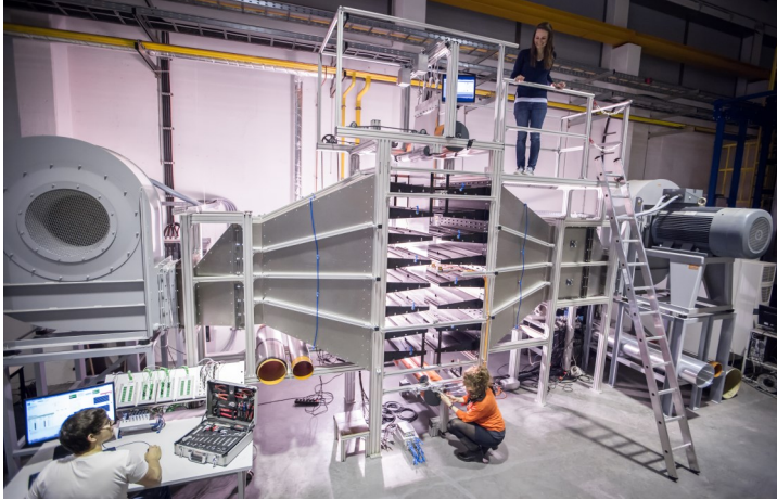
Versuchsstand zur Untersuchung der Bandstabilität
